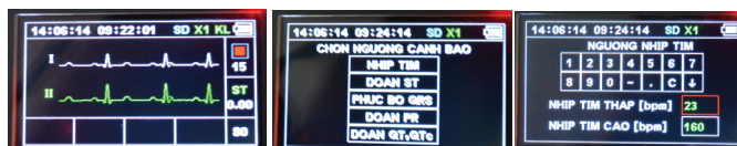
Hiển thị sóng điện tim Chọn ngưỡng cảnh báo Thiết lập ngưỡng
