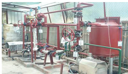
Thiết bị tạo nhũ tương dầu FO - nước thử nghiệm tại Viện Khoa học Năng lượng
