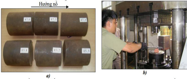
Hình 2: chuẩn bị phiôi biến dạng dẻo từ vật liệu bimetal thép C45 và thép WX15 hàn nổ dạng hình trụ (a) và thí nghiệm ép chảy ở trạng thái nóng (b)
