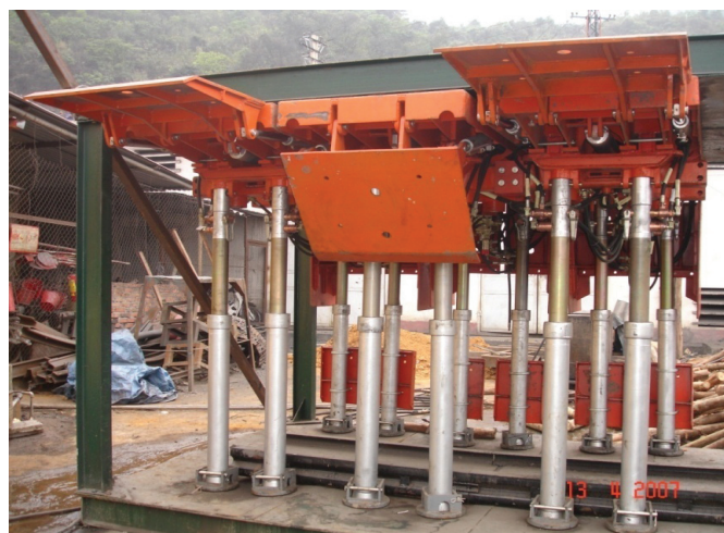
Giá khung thủy lực di động GK1600/1.6/2.4HT do TKV thiết kế, chế tạo
