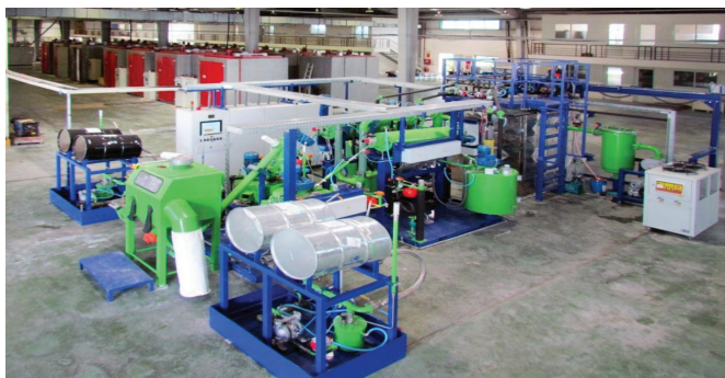
Hình 4: hệ thống dây chuyền thiết bị công nghệ đúc epoxy chân không tiên tiến, hiện đại do Hedrich sản xuất được GELEX đầu tư, sử dụng
