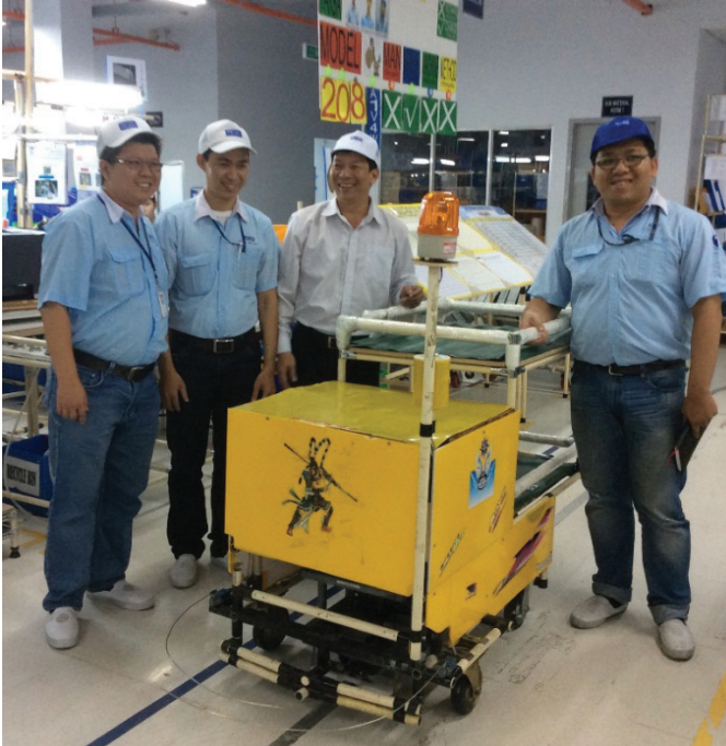
Hình 2: xe tự hành robot AGV, chế tạo tại nhà máy Allied Technology, Khu CNC TP Hồ Chí Minh
