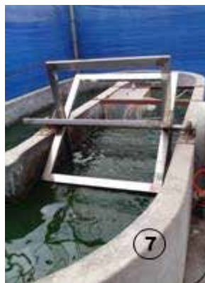
Hệ thống đốt than, xử lý, thu gom, làm sạch khí và nuôi tảo tại Cổ Nhuế và Thạch Bàn (1: lò đốt than; 2: xyclon khử bụi; 3: hộp xúc tác - hấp phụ; 4: tháp hấp thụ; 5: thiết bị nạp CO 2 cao áp; 6: tủ điều khiển; 7: bể nuôi Spirulina)
