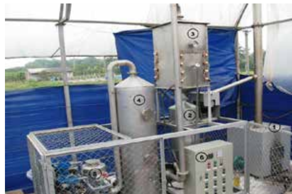
Hệ thống đốt than, xử lý, thu gom, làm sạch khí và nuôi tảo tại Cổ Nhuế và Thạch Bàn (1: lò đốt than; 2: xyclon khử bụi; 3: hộp xúc tác - hấp phụ; 4: tháp hấp thụ; 5: thiết bị nạp CO 2 cao áp; 6: tủ điều khiển; 7: bể nuôi Spirulina)
