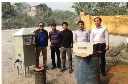
Vận hành thử nghiệm hệ thống thu mẫu bụi lơ lửng TSP trong không khí tại khu vực lân cận Nhà máy xi măng Bút Sơn, tỉnh Hà Nam
