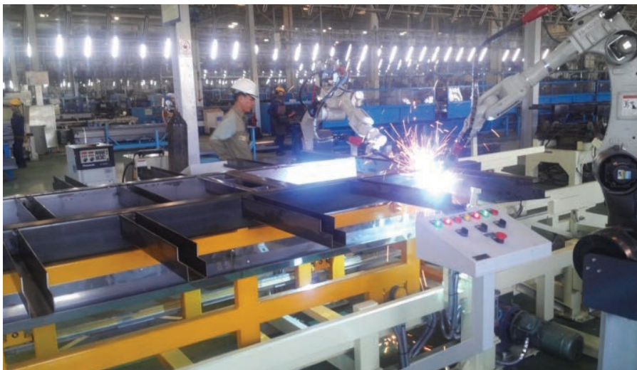
Robot cho dây chuyền hàn sản thùng xe ben trong nhà máy chế tạo ô tô Trường Hải (Đề tài KC03.09/11-15 do Trường chủ trì)
