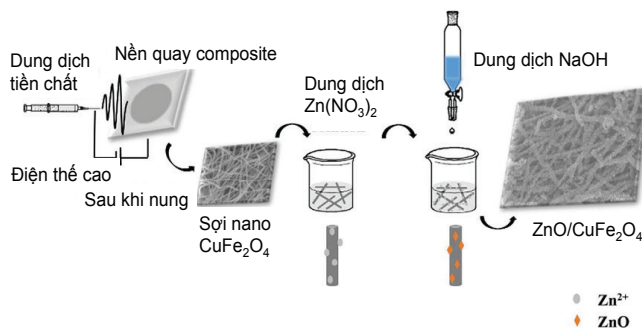
Hình 2. Quy trình tổng hợp hệ vật liệu ghép nối \text{ZnO}/\text{CuFe}_2\text{O}_4 .
