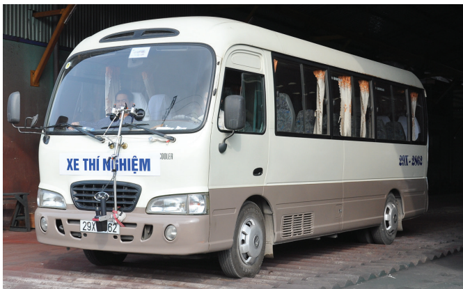
Thí nghiệm xác định hệ số cản giảm chấn bằng phương pháp đo gián tiếp.
