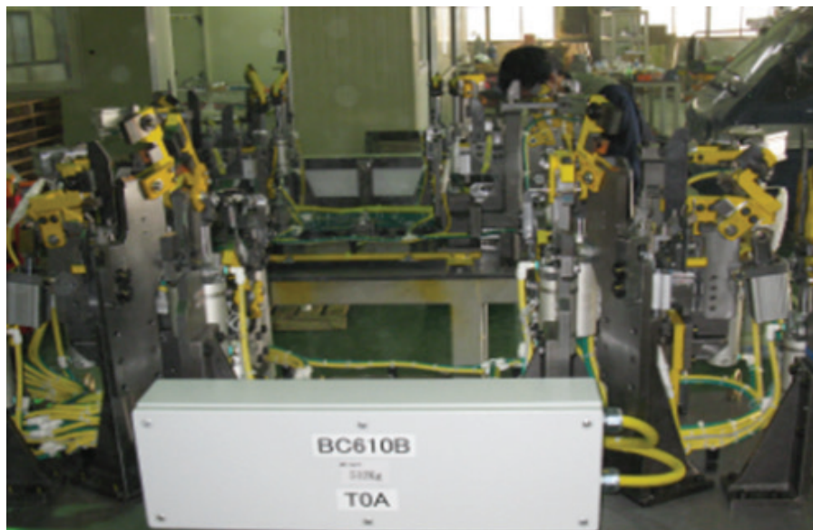
Bộ đồ gá sau khi được chế tạo và lắp ráp tại SEG.
