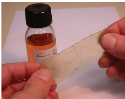
Hình 1. Vật liệu polymer tự hồi phục dựa trên các liên kết hydrogen được tạo ra bởi Ludwik Leibler và các cộng sự tại Học viện Công nghiệp vật lý và hóa học (Paris, Pháp).
