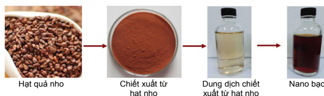
Hình 2. Sơ đồ mô tả quá trình tổng hợp nano bạc từ chiết xuất hạt nho.
