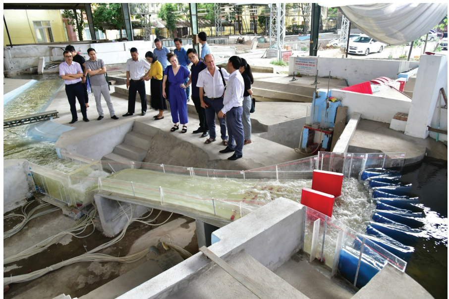
Đoàn Cơ quan Phát triển Pháp (AFD) thăm quan Mô hình thủy lực tràn xả lũ Chà Rang, tỉnh Khánh Hòa tại Phòng Thí nghiệm Trọng điểm Quốc gia về động lực học sông biển.
