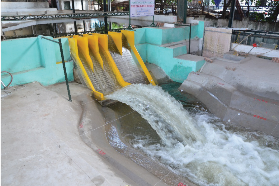
Mô hình thủy lực tràn xả lũ Hồ chứa nước ngòi Giành, tỉnh Phú Thọ.
