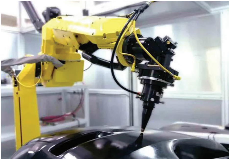
Gia công cắt hình dạng 3D sử dụng tia laser công suất cao.
