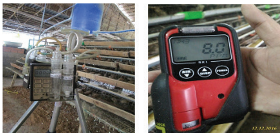
Hình 1. Thiết bị kiểm tra TSVKHK (trái), máy đo nồng độ khí \text{NH}_3 trong không khí (phải)
