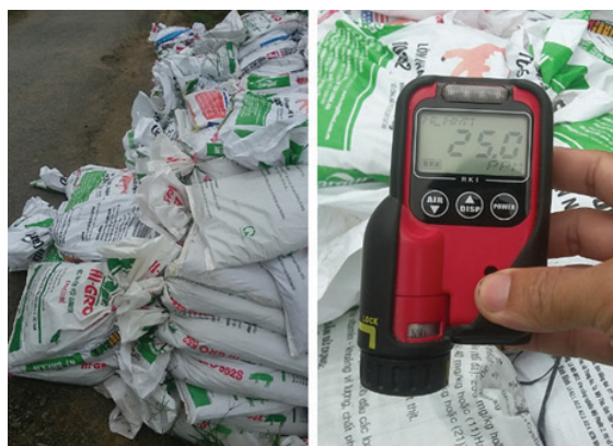
Hình 2. Điểm tập kết và đo nồng độ \text{NH}_3 tại vị trí bên trên đống bao chất lót chuồng
