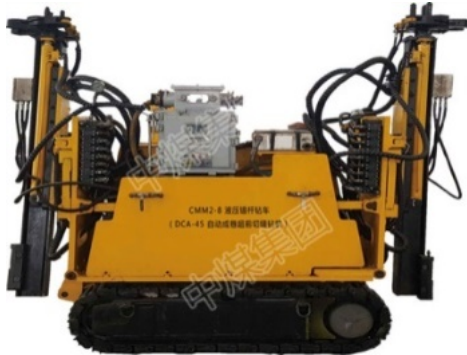
Hình 7. Máy khoan khoan lỗ mìn cắt vách CMM2-8
