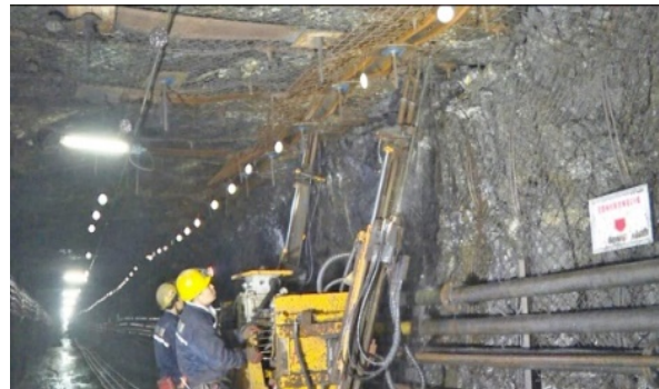
Hình 8. Công tác khoan nổ mìn cắt vách định hướng
