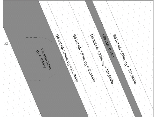
H.1. Sơ đồ cột địa tầng khu vực đường lò phục vụ thiết kế chống neo
