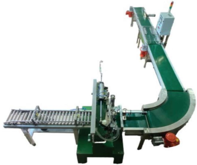
Hình 1. Sơ đồ hệ thống cắt và tuyển chọn thuốc phóng tự động.
