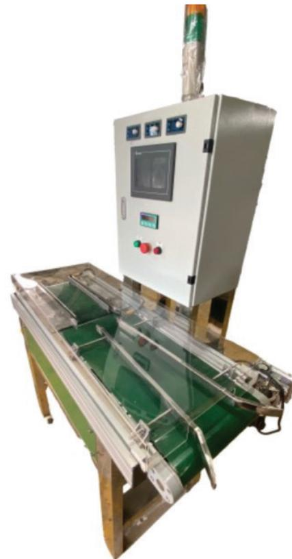
Hình 7. Cân phân loại sản phẩm.
