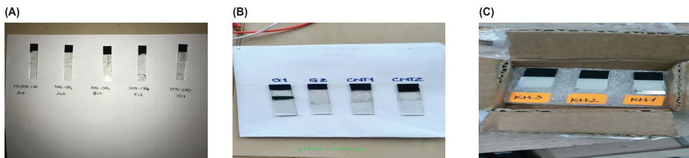
Hình 1. Ảnh chụp điện cực PANI/FTO sau 10 chu kỳ quét thế với tốc độ quét 20 (A), 30 (B) và 40 (C) mV/s.
