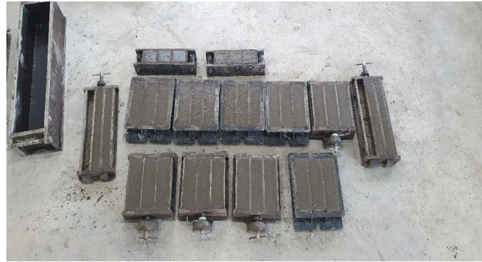
Hình 3. Các mẫu vữa được chuẩn bị.
