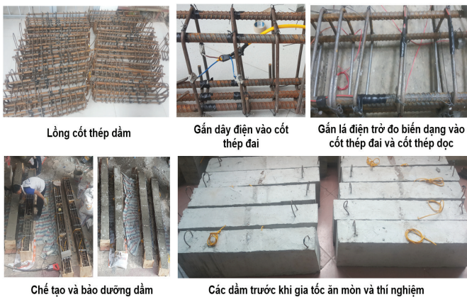
Hình 3. Chế tạo 10 dầm BTCT.
