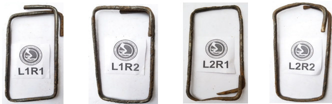
Hình 12. Cốt thép đai được bóc tách khỏi bê tông sau khi thí nghiệm.
