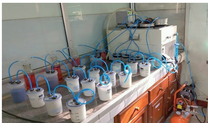
Hình 1. Hệ thống thử nghiệm phân hủy thông qua việc xác định lượng CO 2 sinh ra.
