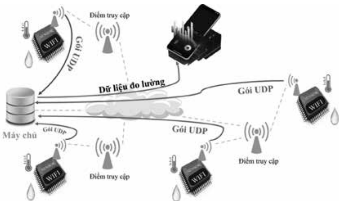
▲ Hình 2. Hệ thống giám sát môi trường với thông tin liên lạc dựa trên UDP
