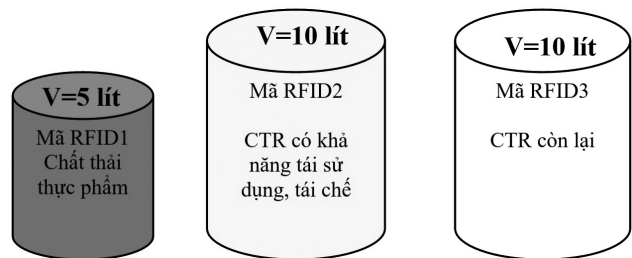
Hình 2. Ba loại thùng chứa CTRSH được dán mã RFID
