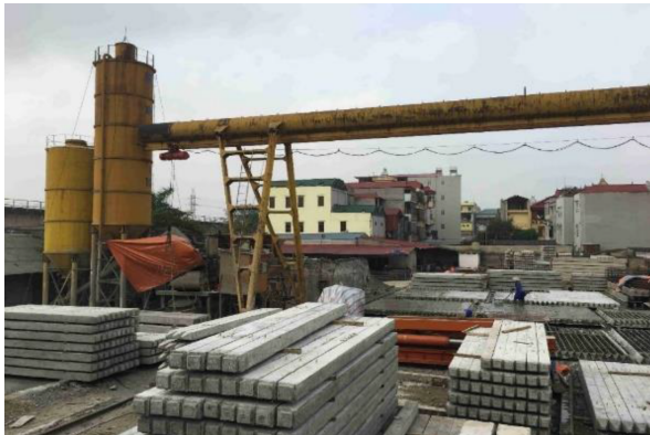
Hình 1. Cọc BTCT tiết diện nhỏ được sắp xếp tại nhà máy
