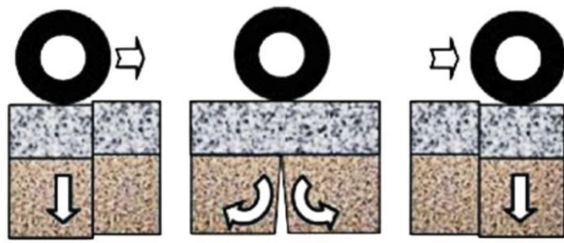
Hình 1. Cơ chế hình thành nứt phản ánh mặt đường BTN dưới tác dụng của tải trọng xe
