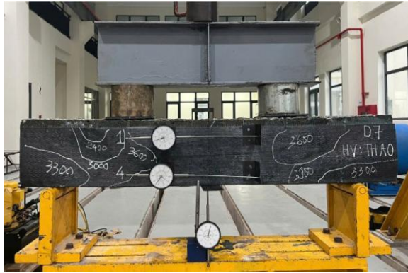
a) Thí nghiệm nén uốn các dầm dán tấm FRP
