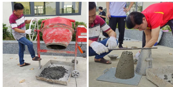
Hình 5. Công tác chuẩn bị vật liệu và kiểm tra độ sụt bê tông đúc mẫu.
