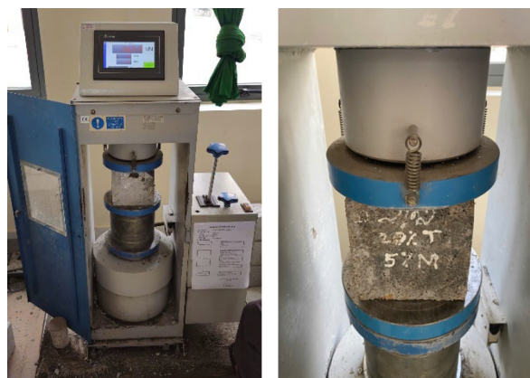
Hình 7. Nén mẫu kiểm tra cường độ chịu nén.
