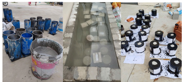
a) Chế tạo mẫu b) Bảo dưỡng c) Quét bitum Hình 4. Quy trình chế tạo và thí nghiệm mẫu thí nghiệm thấm.
