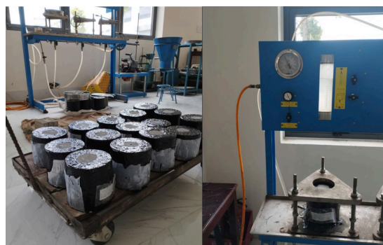
Hình 7. Thí nghiệm độ thấm
