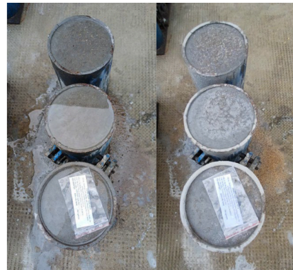
Hình 5. Mẫu vữa thử nghiệm với 20% Sika Grout® trước và sau
