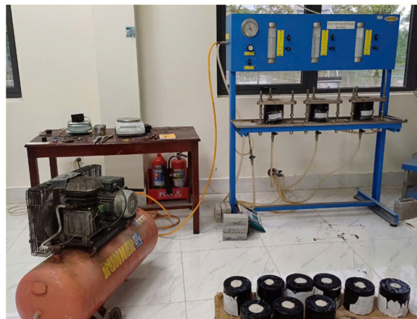
Hình 9. Thiết bị thí nghiệm thấm của các mẫu với các tỷ lệ Sika Grout® [7].
