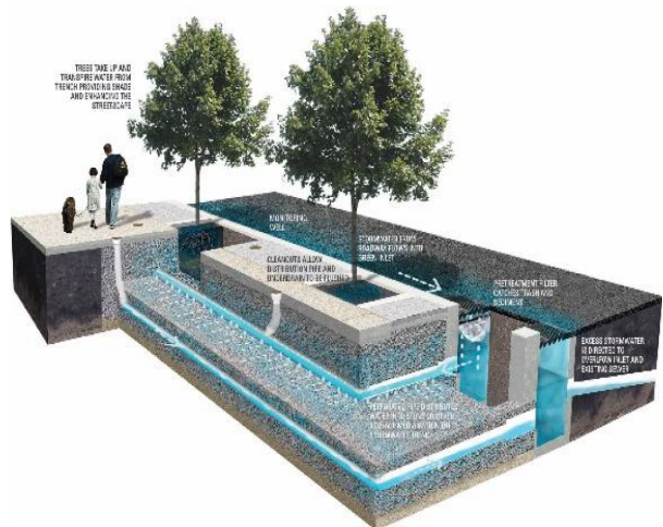
Hình 4. Hồ cây thu nước mưa
