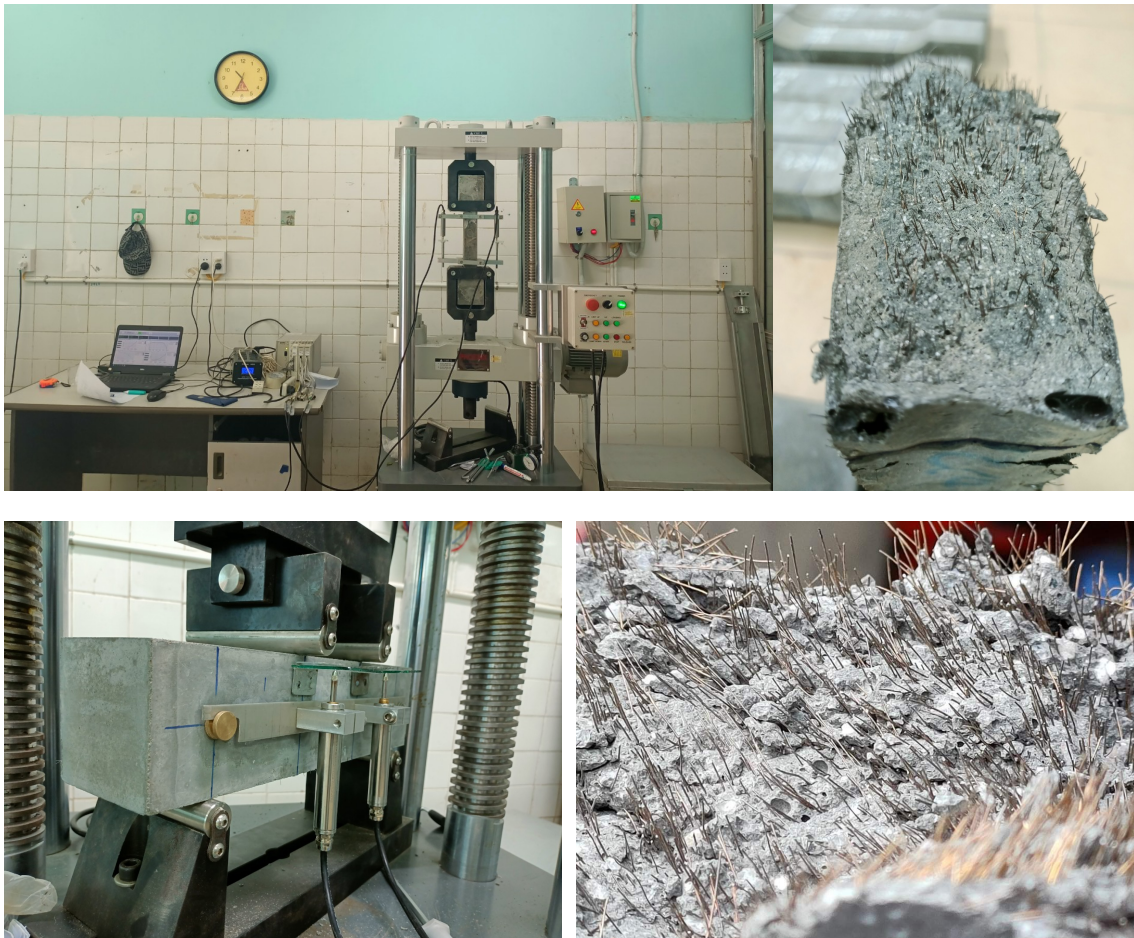
Hình 9. Công tác kiểm tra ứng suất - biến dạng kéo và ứng suất - biến dạng uốn của UHPC
