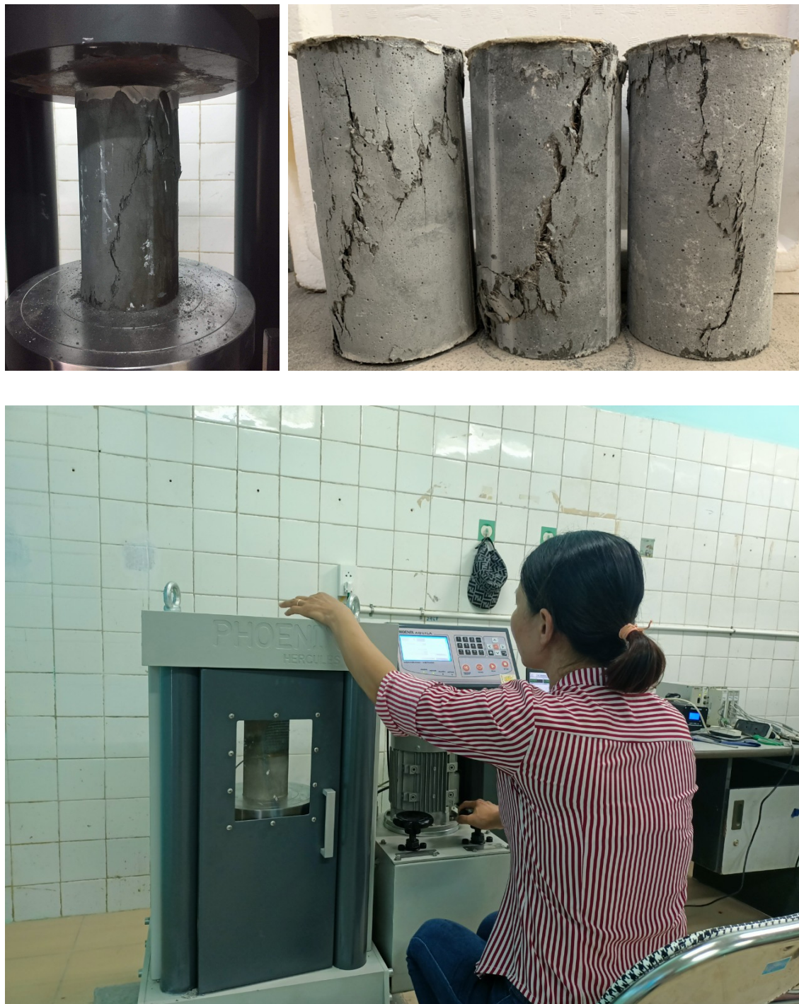
Hình 8. Công tác thử nghiệm cường độ chịu nén và mô đun đàn hồi của UHPC
