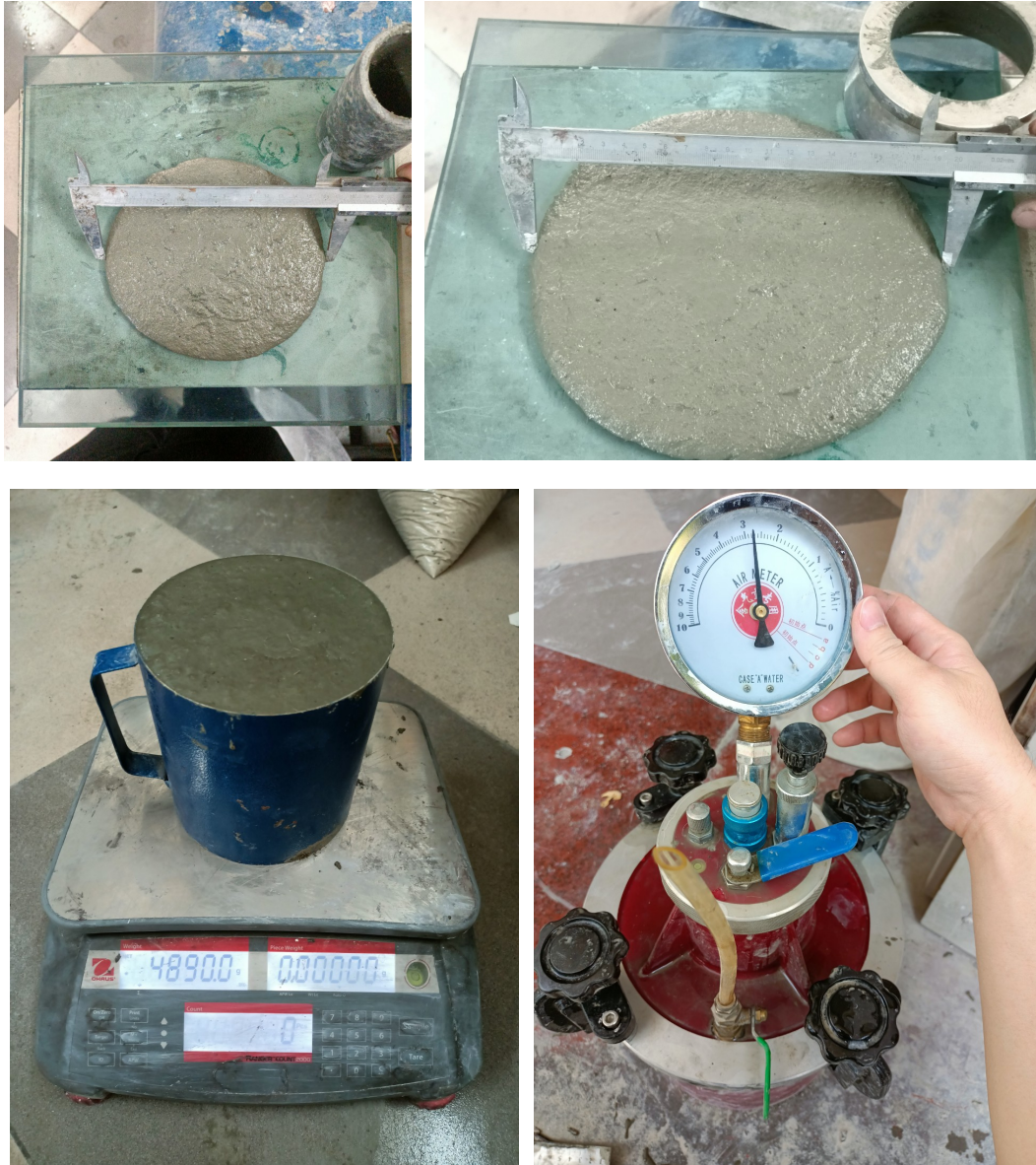
Hình 7. Công tác kiểm tra các tính chất của hỗn hợp UHPC.
