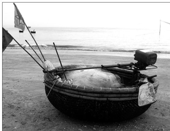
Hình 6: Thuyền thúng gắn động cơ có trục dài ở Ròn.
