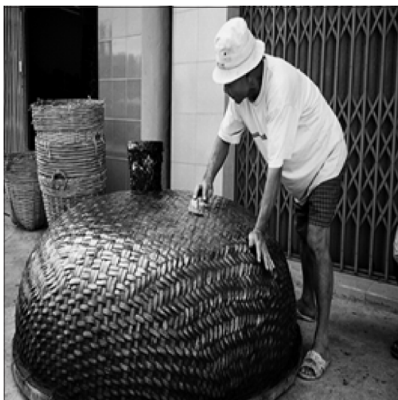
Hình 2: Chống thấm nước bằng nhựa thông và phân bò.
