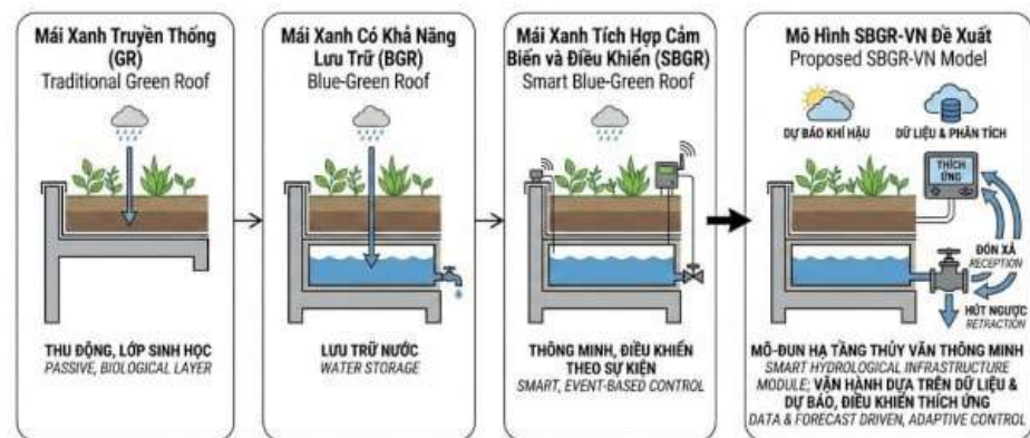
Hình 6: Tiến trình phát triển của hệ mái xanh trong quản lý nước mưa đô thị, từ mái xanh truyền thống (GR) đến mô hình SBGR - VN đề xuất. Ảnh. Tác giả
