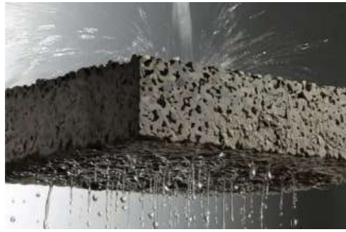
Hình 10. Sử dụng vật liệu bề mặt thấm, kết sinh thái và bê tông thấm tiêu cho các bề mặt hoàn thiện làm tăng khả năng hút nước mưa và cải thiện thoát nước mặt và giảm áp lực hạ tầng kỹ thuật đô thị. (Nguồn: Trái) https://www.thespruce.com ; Phải) https://vnbuilding.vn/ )
