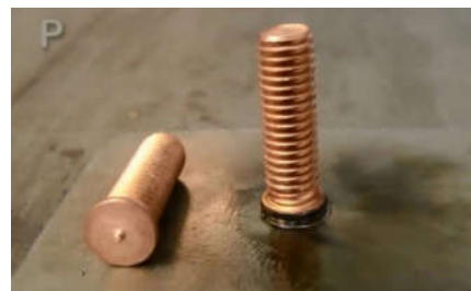
Hình 8. Đinh có ren sau khi hàn lên bề mặt kim loại dạng tấm [3]
