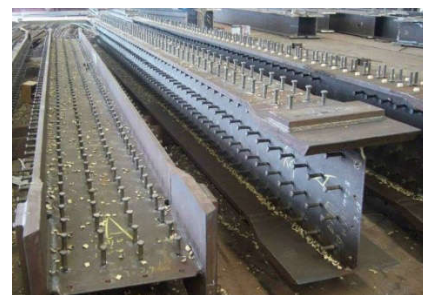
Hình 15. Hàn đỉnh thép trên dầm
