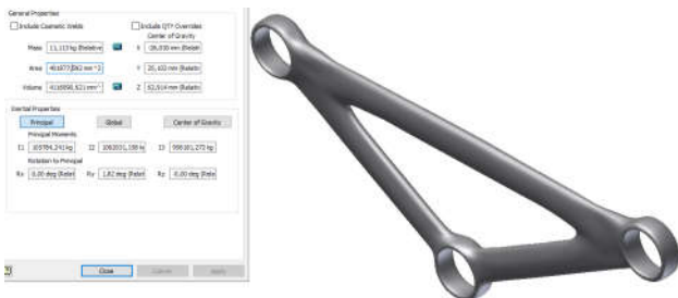
Hình 14. Mô hình 3D của chi tiết tay đòn sau khi Generative Design
