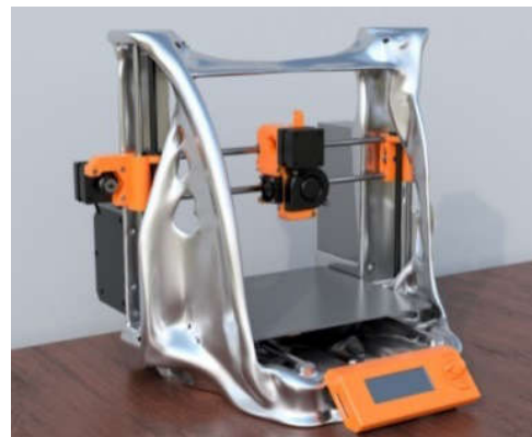
Hình 1. Tối ưu hóa cấu trúc khung máy in 3D
