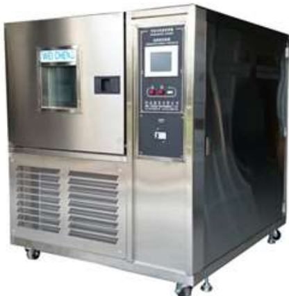
Hình 1. Buồng kiểm soát nhiệt độ, độ ẩm Temperature & Humidity chamber
