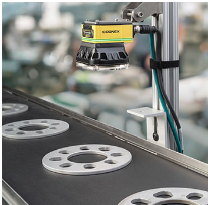
Hình 1. Máy phát hiện lỗi trên bề mặt sản phẩm cơ khí chạy trên băng tải
