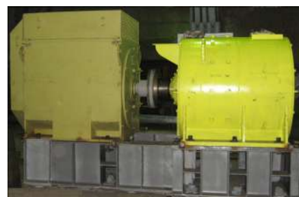
Hình 15. Bộ thử nghiệm với máy phát điện một chiều
