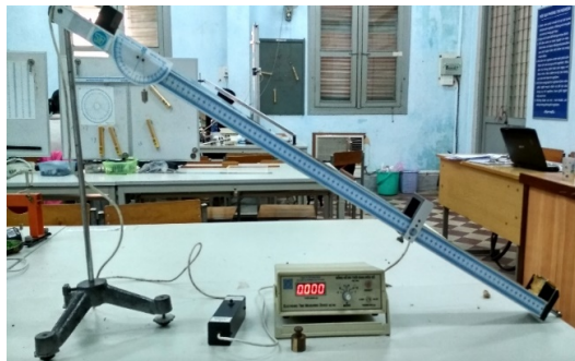
Hình 9. Bộ thí nghiệm đo hệ số ma sát theo phương pháp mặt phẳng nghiêng Tại Phòng Thí nghiệm Vật lý phổ thông – Trường Đại học Sư phạm TPHCM
