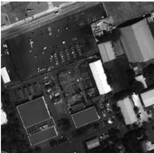
Hình 5: Mối liên hệ giữa hình dạng mái và DHM, sử dụng để tính toán độ dốc mái
