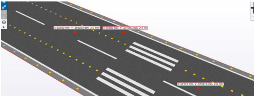
Hình 8. Kiểm tra độ dốc đường cất hạ cánh
