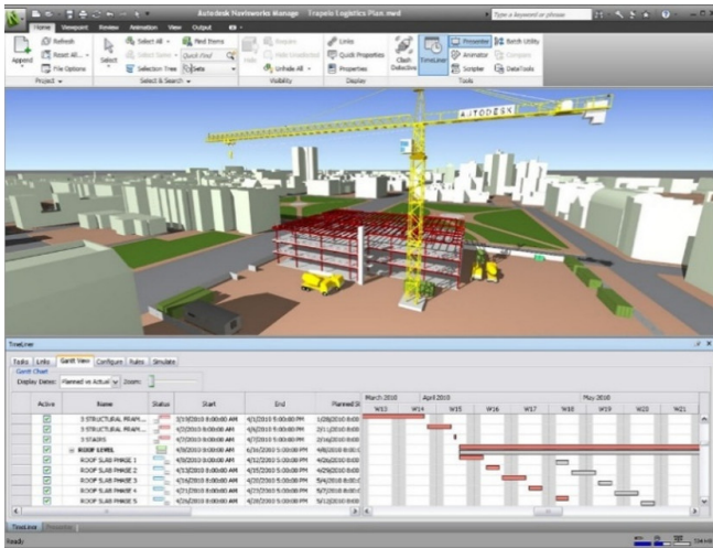
Hình 2. BIM trong theo dõi tiến độ và kiểm soát khối lượng thi công thực tế [24]
