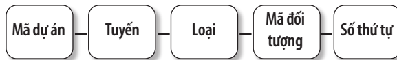
Hình 4 - Mã cấu liên cho công trình hạ tầng trong tài liệu EIR của Úc [8]
