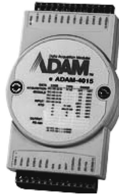
b) Thiết bị đo nhiệt độ cáp
