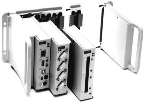
a) Thiết bị thu thập dữ liệu dao động
