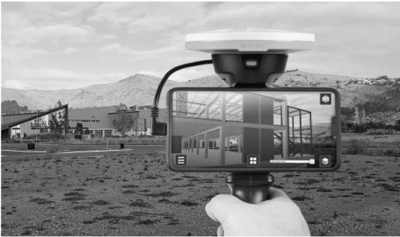
Hình 1: Thiết bị AR cầm tay Trimble SiteVision
