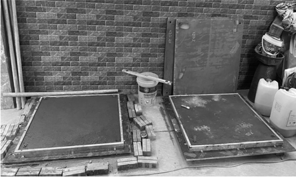
Hình 1: Mẫu bản UHPC kích thước 1,00 x 1,00m dày 5cm
