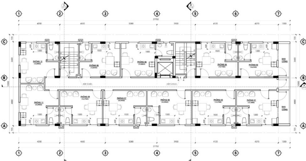
Hình 2: Mặt bằng tầng điển hình tầng 2, 3, 4, 5 của một chung cư mini mặt tiền đường đô thị, diện tích căn hộ 20-25m 2 (xin phép xây dựng năm 2023)
